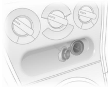
Uma saída de alimentação de 12 V está situada na consola central e funciona com o interruptor de ignição ligado nas posições: **ACC** ou **ON**.
