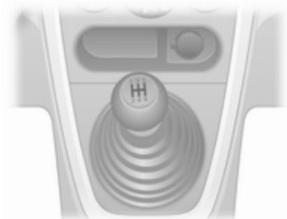
Marcha-atrás: Com o veículo parado, aguarde 3 segundos depois de pressionar o pedal da embraiagem e engrenar a mudança.
