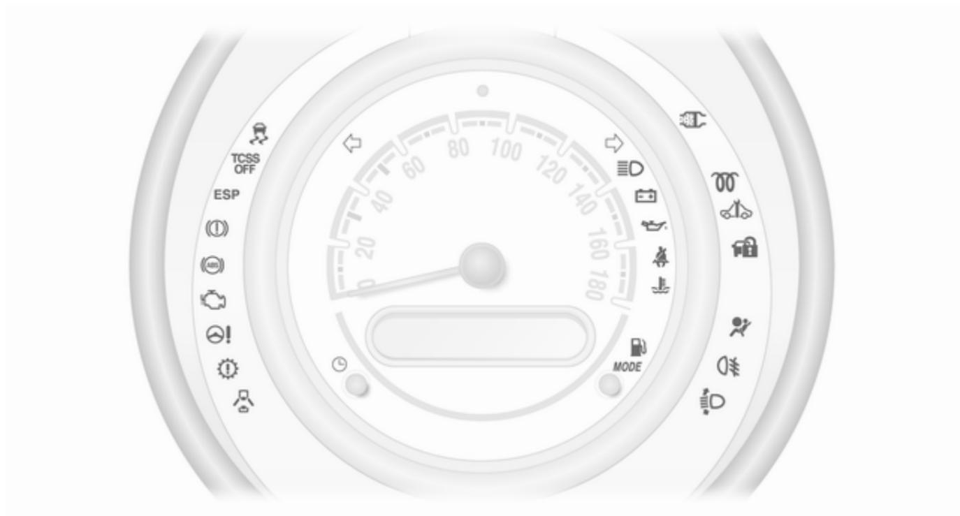
As luzes de aviso descritas não fazem parte de todos os veículos. A descrição aplica-se a todas as versões de instrumentos. Quando se liga a ignição, a maior parte das luzes de aviso acendem-se por breves instantes para efeitos de teste de funcionalidade.
