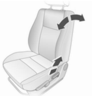
Puxar a alavanca, regular a inclinação e soltar a alavanca. Deixar que o banco encaixe até ouvir o barulho de encaixe.
