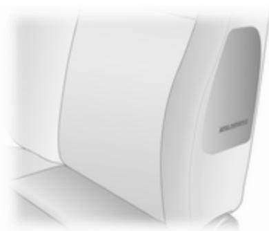
O sistema de airbags laterais é constituído por um airbag em cada um dos encostos dos bancos dianteiros. Estes airbags podem ser identificados pelas palavras **SRS AIRBAG**.
