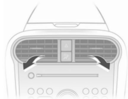
O fluxo do ar pode ser orientado conforme pretendido inclinando as palhetas para cima, baixo ou para os lados usando o regulador central.
