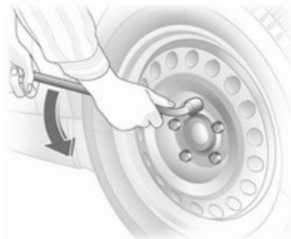
2. Colocar uma chave de rodas assegurando que fica bem colocada e afrouxar cada parafuso meia volta.
