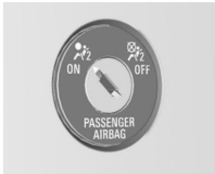
O sistema de airbag do passageiro da frente pode ser desactivado numa tranca na lateral do painel de instrumentos, visível quando a porta dianteira do passageiro está aberta.
