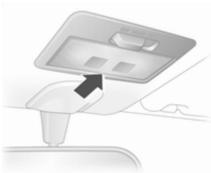
1. Usando uma chave de fendas adequada coberta por um pano, arranque a lente para fora do forro do tecto.
