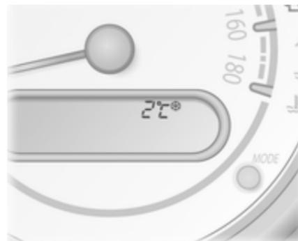
A temperatura exterior é mostrada no mostrador do conta-quilómetros quando se liga a ignição.
