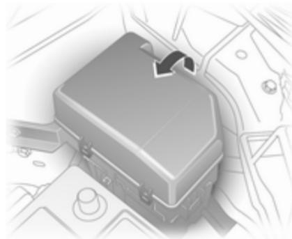
A caixa de fusíveis está situada junto à bateria no compartimento do motor.
