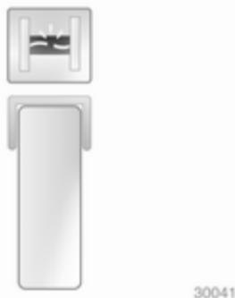
Um fusível fundido terá um fio derretido. Não substituir o fusível enquanto não se corrigir o que levou a que se fundisse.
