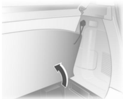
Para aceder ao compartimento de arrumos do piso traseiro, levante o tapete utilizando a cinta central situada junto ao trinco da porta traseira e pendure a correia no gancho.
