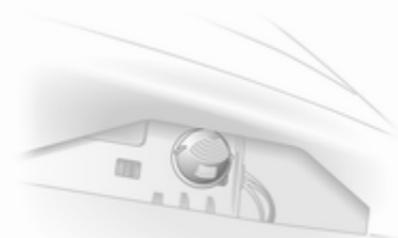
1. Desmonte o suporte da lâmpada rodando-o e afastando-o do veículo.
