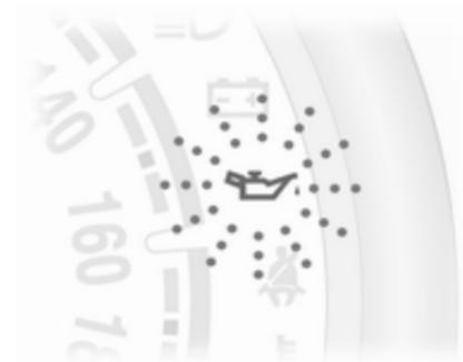
Quando o sistema tiver calculado uma redução na vida útil do óleo, acende-se 🛑 no painel de instrumentos quando o motor estiver a trabalhar. Mandar mudar o óleo do motor e o filtro numa oficina no espaço de uma semana ou 500 km (conforme a que ocorrer primeiro).
