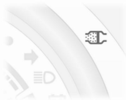
Em determinadas condições de condução, p. ex. em pequenos percursos, o sistema não se pode limpar a si próprio automaticamente.
