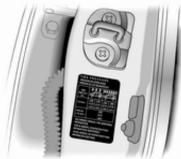
Os dados da pressão dos pneus referem-se a pneus frios. Aplica-se a pneus de Verão e de Inverno.
