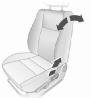
Puxar a alavanca, regular a inclinação e soltar a alavanca. Deixar que o banco encaixe até ouvir o barulho de encaixe. Não se encostar nas costas do banco quando se estiver a proceder à regulação.
