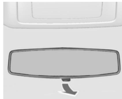
Rodar a alavanca na parte inferior para reduzir o encandeamento.
