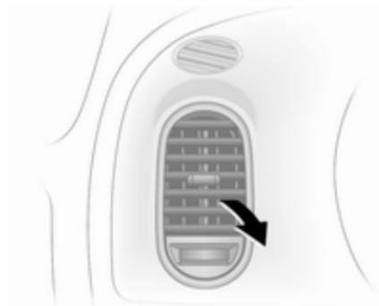
Oriente o fluxo do ar inclinando as palhetas e rodando a roda de ajuste para a esquerda ou para a direita.
