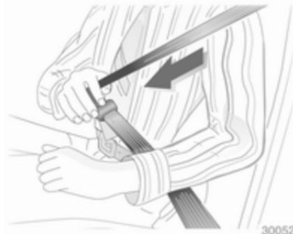
Puxar o cinto do carreto; sem torcer, colocar sobre o corpo e engatar a lingueta metálica no fecho. Ajustar a tensão da faixa do cinto que passa pelo abdómen regularmente puxando a faixa que passa pelo ombro.
