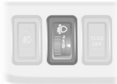
Para ajustar o alcance dos faróis à carga do veículo, para evitar encandeamento: rodar o botão para a respectiva posição.
