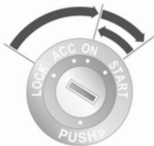
Rode a chave para a posição **ACC**. Rode o volante ligeiramente para libertar o bloqueio do volante. Accionar a embraiagem e o travão, caixa de velocidades automática em **N** ou **P**, não acelerar; em motores a diesel, rodar a chave para a posição **ON** para pré-aquecimento e esperar até a luz de aviso se apagar; rodar a chave para **START** e largar a chave.
