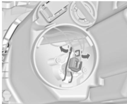
3. Desencaixar o grampo de mola do fixador pressionando para a frente e depois deslocando para baixo.
