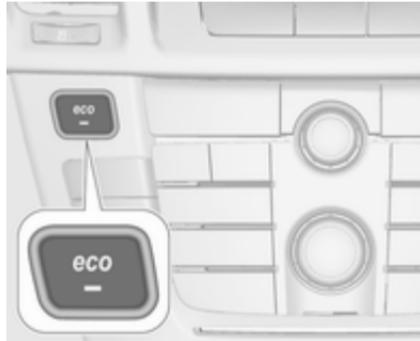
Desactivar manualmente o sistema Start/Stop carregando no botão **eco**. A desactivação é indicada pelo LED que apaga no botão.
