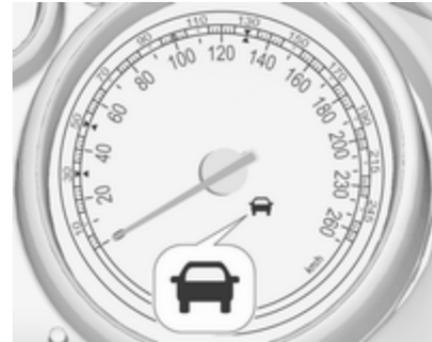
A luz verde de controlo indicadora de veículo à frente
