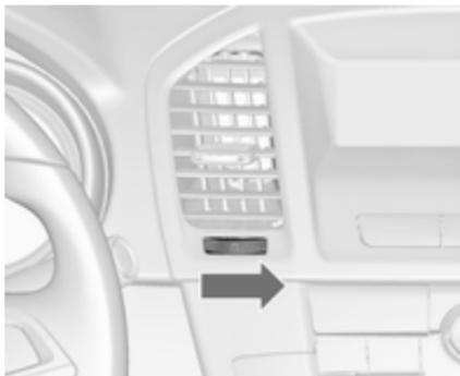
Para abrir a saída de ar, rodar o regulador para I. Ajustar a quantidade de ar na saída de ar, rodando o botão rotativo de ajuste.
