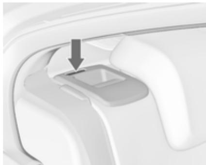
Os encostos estão correctamente encaixados quando as duas marcas vermelhas na lateral perto da alavanca de desengate deixam de se ver.
