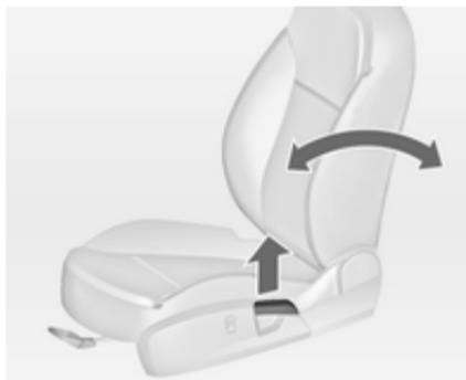
Puxar a alavanca, regular a inclinação e soltar a alavanca. Deixar que o encosto do banco encaixe audivelmente.
