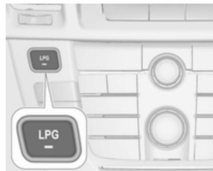
Premir o botão **LPG** para comutar entre o funcionamento a gasolina e a gás liquefeito logo que os parâmetros necessários (temperatura do líquido de arrefecimento, temperatura do gás e rotação mínima do motor) tenham sido atingidos. Os requisitos são atingidos após aproximadamente 60 segundos (consoante a temperatura exterior) e a primeira vez que o acelerador é pressionado com mais intensidade. O estado do LED mostra o modo de funcionamento actual.
