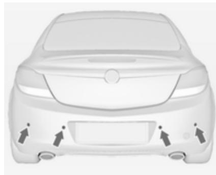
Os sensores de estacionamento facilitam o estacionamento medindo a distância entre o veículo e os obstáculos emitindo sinais acústicos. É no entanto o condutor que continua totalmente responsável pelo acto de estacionar.
