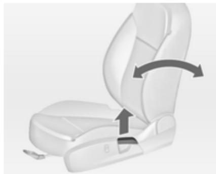
Puxar a alavanca, regular a inclinação e soltar a alavanca. Deixar que o banco encaixe de forma audível.
