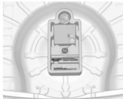
As ferramentas e o olhal de reboque encontram-se juntamente com o kit de reparação de pneus numa caixa de ferramentas por baixo da cobertura do piso na bagageira.
