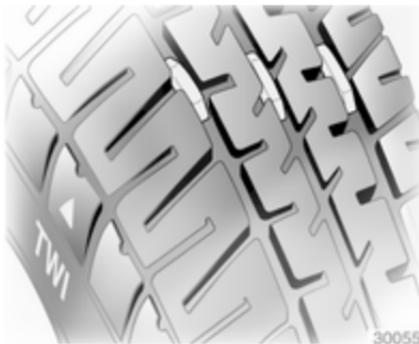
A profundidade de rasto mínima permitida por lei (1,6 mm) terá sido atingida quando o rasto tiver sido gasto até um dos indicadores de desgaste do rasto (TWI). A sua posição é indicada pelas marcas na parede lateral.
