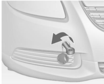
Enroscar o olhal de reboque o mais possível e até parar na horizontal. Prender um cabo de reboque - ou, ainda melhor, uma barra de reboque - ao olhal de reboque.
