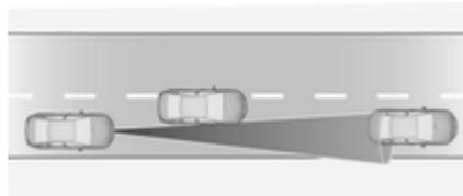
Se outro veículo entrar no trajecto de condução do veículo, o programador de velocidade adaptável só considera o veículo quando este estiver completamente dentro do trajecto. O
