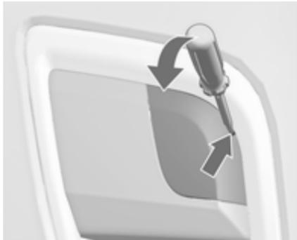
**Insignia OPC:** Inserir uma chave de parafusos na ranhura da dobra superior da tampa. Soltar a tampa deslocando cuidadosamente a chave de parafusos para baixo. Para evitar danos, recomenda-se colocar um pano entre a chave de parafusos e o aro.
