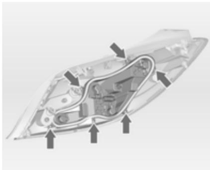
4. Desaparafusar os parafusos e retirar o suporte da lâmpada.
