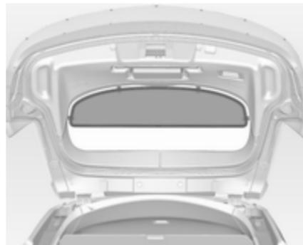
Para cobrir completamente a bagageira, montar a persiana nos quatro pontos de fixação no interior da porta da bagageira.
