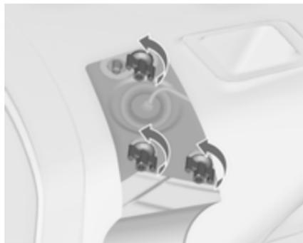
2. Desaparafuse as três porcas de fixação em plástico à mão.
