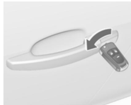
Destrancar manualmente a porta do condutor rodando a chave na fechadura. Ligar a ignição e pressionar o botão do fecho centralizado
