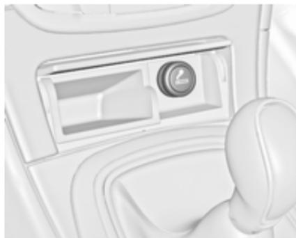
Pressionar o isqueiro. Desliga automaticamente assim que o elemento está incandescente. Puxar o isqueiro para fora.
