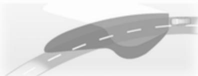
Os feixes dos faróis rodam conforme o ângulo do volante e a velocidade, melhorando a iluminação nas curvas. Indicador de controlo ☸ ⇨ 103.
