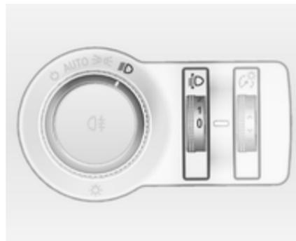
Para adaptar o alcance dos faróis à carga do veículo, para evitar encandeamento: rodar o botão de posicionamento manual
