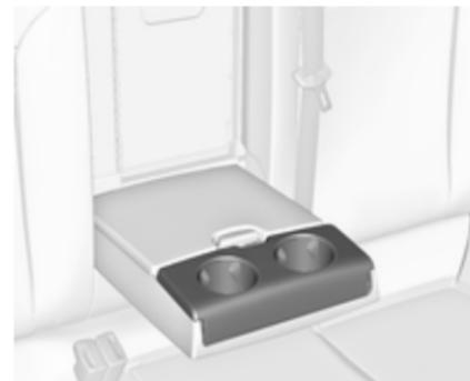
No apoio de braços traseiro, há suportes adicionais para copos. Rebater o apoio de braços.
