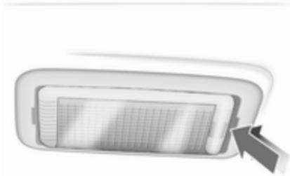
1. Retirar a lâmpada para fora com uma chave de parafusos.
