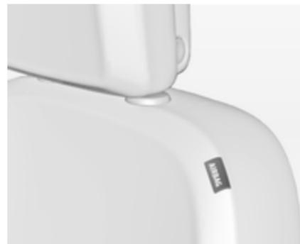
O sistema de airbag lateral consiste num airbag em cada um dos encostos do banco dianteiro e nos encostos dos bancos exteriores traseiros. Estes airbags podem ser identificados pela palavra **AIRBAG**.
