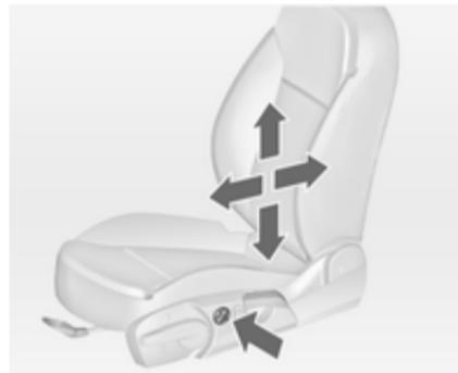
Ajustar o apoio lombar usando o interruptor de quatro vias para o adaptar às necessidades pessoais.
