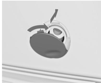
Inserir a tampa na base, rodar ligeiramente para a direita e encaixar a tampa.
