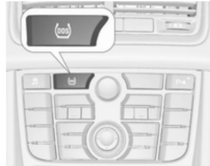
Depois de corrigir a pressão de um pneu ou de mudar uma roda, é preciso inicializar o sistema: Ligar a ignição, pressionar e manter o botão **DDS** durante cerca de 4 segundos.
