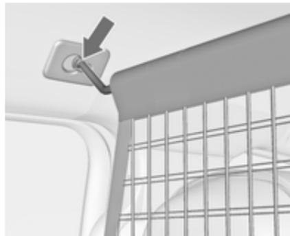
Há duas aberturas e de montagem na estrutura do tejadilho: rolo suspenso de rede de um lado, puxar para a frente e encaixar. Esticar o rolo, suspender no lado oposto, empurrar para a frente e encaixar.
