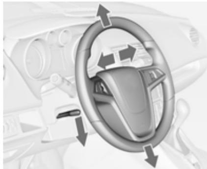
Destrançar a alavanca, ajustar o volante, e depois engatar a alavanca e assegurar que fica totalmente trancada.
