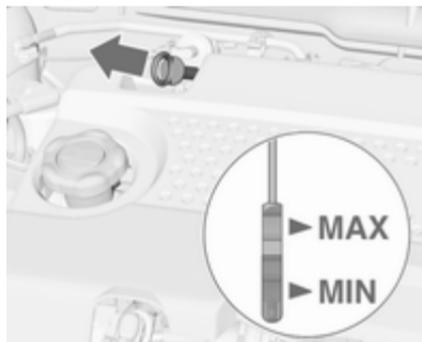
Quando o nível do óleo do motor for inferior à marca **MIN**, atestar com óleo do motor.
