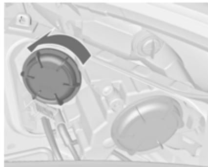
1. Rodar a tampa protectora 2 para a esquerda e retirar.
