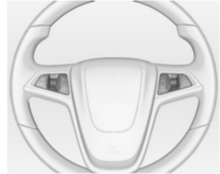
O sistema de informação e lazer, o programador de velocidade e um telemóvel ligado podem funcionar através dos comandos no volante.
