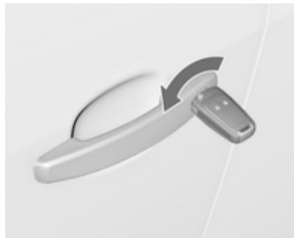
Destrancar manualmente a porta do condutor rodando a chave na fechadura. Ligar a ignição e pressionar o botão do fecho centralizado para destrancar todas as portas, bagageira e portinhola do depósito de combustível. Ligando a ignição, a Protecção anti-roubo é desactivada ⇨ 29.
