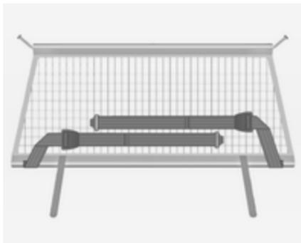
Colocar as fitas tensoras conforme se mostra na figura e alinhar com a rede.
