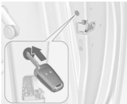
Inserir a chave na abertura acima do fecho no interior da porta e accionar o fecho pressionando até ouvir um clique. Depois, fechar a porta. Este procedimento deve ser efectuado em cada porta. A porta do condutor também pode ser trancada pelo lado de fora com a chave. A portinhola do depósito de combustível e a porta da bagageira não podem ser trancadas.
