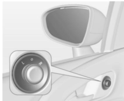
Seleccionar o espelho retrovisor exterior relevante rodando o controlo para a esquerda (L) ou para a direita (R). Depois, rodar o comando para regular o espelho retrovisor.
