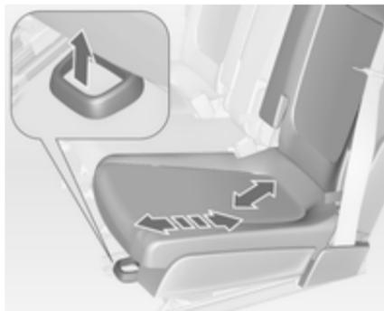
Os bancos traseiros junto às janelas podem ser deslocados individualmente para a frente ou para trás. Os bancos podem ser deslocados longitudinal e transversalmente.
