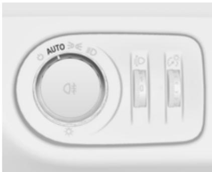
Quando a função de controlo automático da iluminação é ligada e o motor está a trabalhar, o sistema alterna entre luzes de condução diurna e faróis conforme as condições de iluminação.
