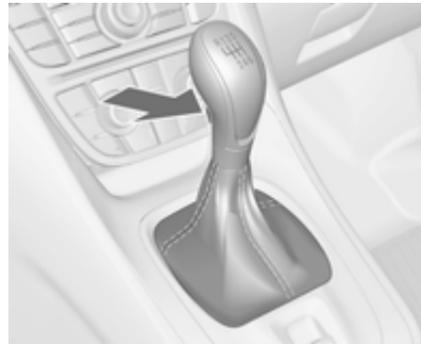
Para engatar a marcha-atrás, com o veículo parado pressionar o botão de desengate na alavanca selectora e engatar a velocidade.
