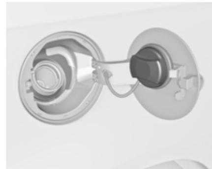
A tampa do tubo de enchimento de combustível pode ser colocada no suporte, na portinhola do depósito de combustível.
