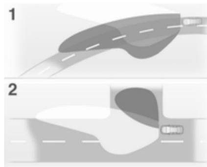
O feixe roda com base na posição do volante e na velocidade.
