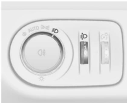
Para adaptar o alcance dos faróis à carga do veículo, para evitar encandeamento: rodar o botão de accionamento manual para a posição necessária.
