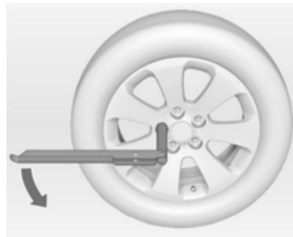
Desdobrar a chave de rodas e instalar certificando-se que fica bem colocada e desaparafusar cada parafuso meia volta.
