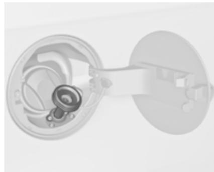
**Adaptador ACME:** Enroscar a porca da ponteira de enchimento no adaptador. Pressionar para baixo o gatilho de bloqueio na ponteira de enchimento.
