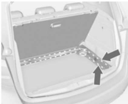
Caso esteja montado na posição superior, o espaço entre o piso do compartimento de carga e a cavidade da roda sobresselente pode ser utilizado como compartimento de arrumação.
