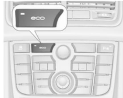
Desactivar manualmente o sistema Start/Stop carregando no botão **eco**. A desactivação é indicada pelo LED que se apaga no botão.
