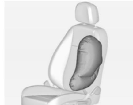
Os airbags cheios amortecem o impacto, reduzindo consideravelmente o risco de ferimentos na parte superior do corpo e da pélvis, no caso de colisão lateral.
