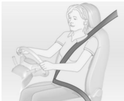
Ajustar a altura de forma a que o cinto fique sobre o ombro. Não deve ficar sobre a garganta ou parte superior do braço.
