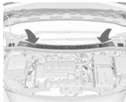
As entradas de ar à frente do pára-brisas no compartimento do motor deverão permanecer desobstruídas de modo a permitir a entrada de ar. Retirar quaisquer folhas, sujidade ou neve.
