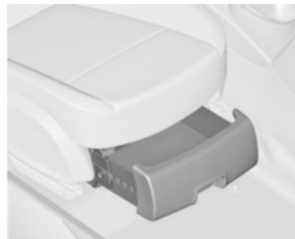
Levantar a gaveta na extremidade com reentrância e puxar para fora. Carga máxima: 3 kg. Para fechar, empurrar a gaveta para dentro e encaixar.
