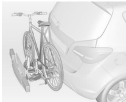
O sistema de suporte traseiro (sistema Flex-Fix) permite a fixação de bicicletas num suporte extraível integrado na base do veículo. O transporte de outros objectos não é permitido.
