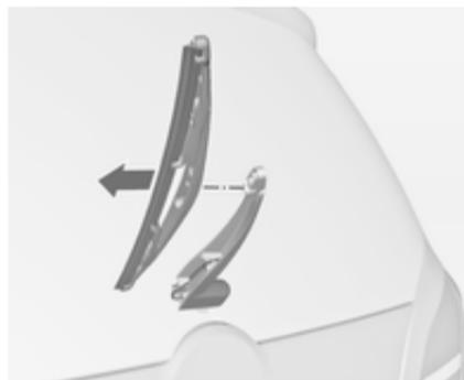
Levantar o braço do limpador de pára-brisa. Desengatar a escova do limpador de pára-brisa conforme se mostra na ilustração e retirar.
