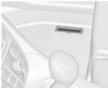
O Número de identificação do veículo está gravado na placa de identificação e no piso do veículo, por baixo do tapete, visível por baixo de uma cobertura.
