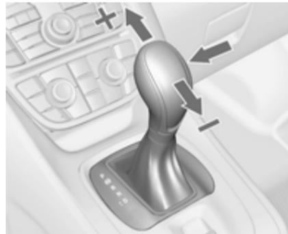
Retirar a alavanca selectora da posição **D** para a esquerda e depois para a frente ou para trás.
