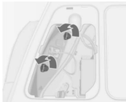
2. Desapertar as duas porcas de fixação em plástico, pelo lado de dentro e à mão.
