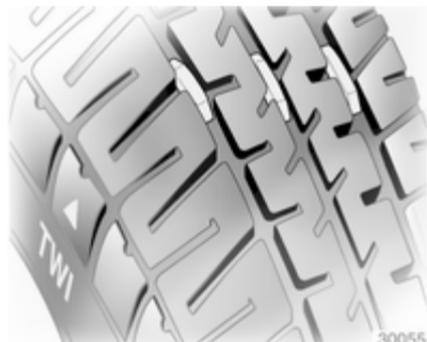
A profundidade de rasto mínima permitida por lei (1,6 mm) foi atingida quando o rasto tiver sido gasto até um dos indicadores de desgaste do rasto (TWI). A sua posição é indicada pelas marcas na parede lateral.
