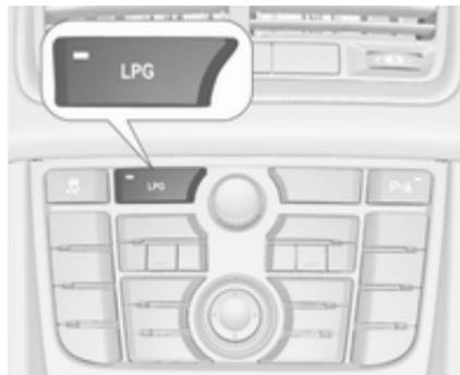
Premir o botão **LPG** comuta entre o funcionamento a gasolina e a gás liquefeito. O estado do LED ● mostra o modo de funcionamento actual.
