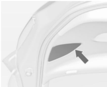
1. Abrir a tampa da bagageira e retirar a tampa com uma chave de parafusos.
