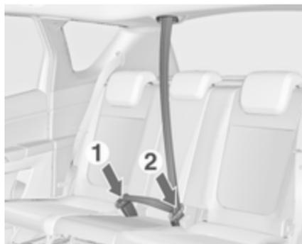
Encaixar a placa de engate inferior no fecho do lado direito (1) no banco do meio. Retirar a placa de engate superior do enrolador, passá-la pelo ombro e zona do abdómen com o cinto (não torcer) e encaixar no fecho do lado esquerdo (2) no banco do meio.
