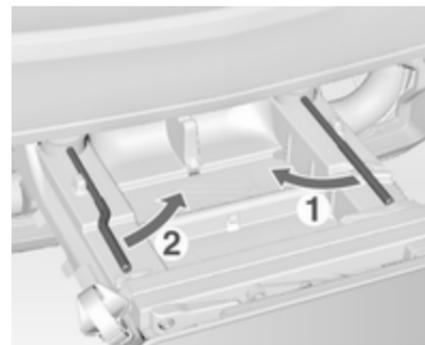
Rodar primeiro a alavanca de engate direita (1), seguida da alavanca de engate esquerda (2), até sentir resistência.
