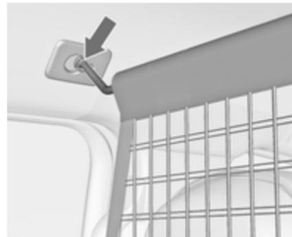
Há duas aberturas de montagem na estrutura do tejadilho: rolo suspenso de rede de um lado, puxar para a frente e encaixar. Esticar o rolo, suspender no lado oposto, empurrar para a frente e encaixar.
