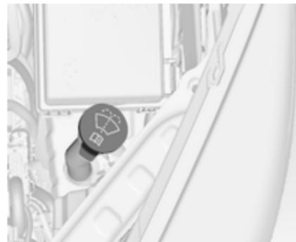
Encher com água limpa misturada com uma quantidade adequada de líquido do lava-vidros que contenha anticongelante. Para a proporção correcta, consultar o recipiente do líquido limpa-vidros.
