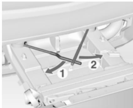
Rodar primeiro a alavanca de engate esquerda (1), seguida da alavanca de engate direita (2), até pararem.
