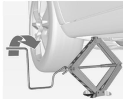
Colocar a manivela do macaco e com o macaco bem alinhado rodar a manivela até a roda ficar afastada do solo.
