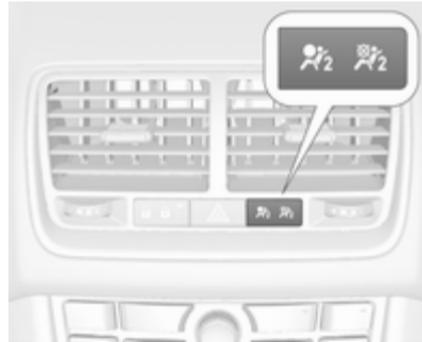
Se o indicador de controlo
