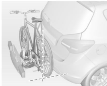
Alinhar a bicicleta na direção longitudinal do veículo: Desapertar um pouco a estrutura do pedal.
