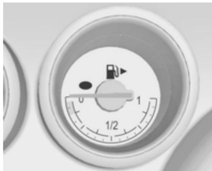
Indica o nível do combustível ou o nível de gás no depósito, consoante o modo de funcionamento.
